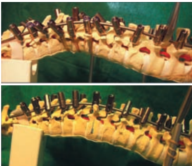
Abbildung 3 zeigt die Korrektur nochmals in der Seitansicht. Der Stab ist an die gewünschte Kyphose angepasst und die Wirbelkörper werden langsam an ihn herangeführt. Durch die Überkonturierung des konkaven Stabes kann die Derotation noch unterstützt werden. Bei der Wiederherstellung der Kyphose sollte auch die Flexibilität und Plastizität des Titanstabes berücksichtigt werden.
